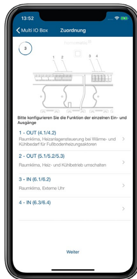
Abbildung 56: Screenshot Kanalübersicht HmIP-MIOB für Energiesparmodus Kühlbetrieb
